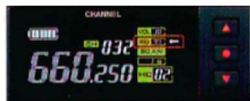
**Меню 2: Регулировка расстояния приема сигнала**
